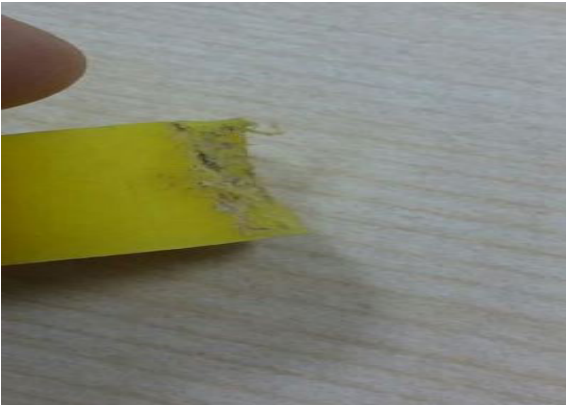
Kanalizasyon menholüne yakın giden PE hatlarda fare kemirmesi sonucu hasar oluşması
