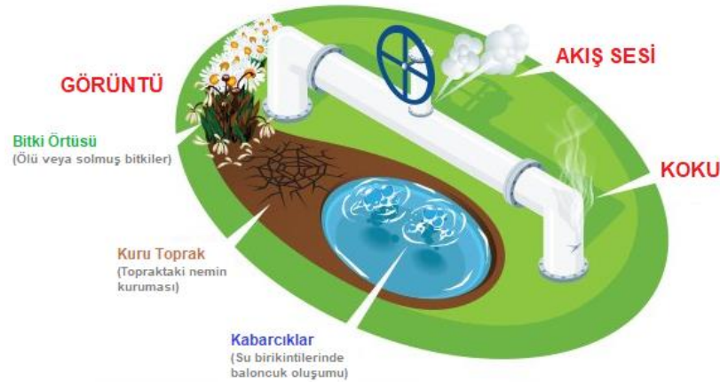
Şekil 3: Doğal gaz boru hatlarında bazı gaz sızıntısı uyarı belirtileri
