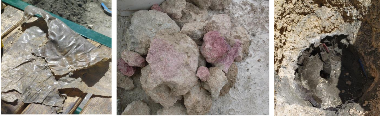
Resim 5: Doğal gaz sızıntısına uzun süre maruz kalan malzeme formlarındaki örnek değişimler
